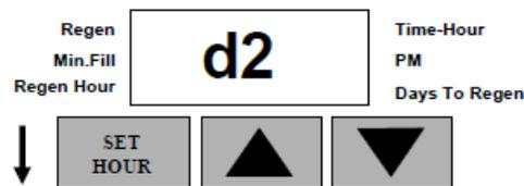
**Regeneration am Montag:** um am Montag zu regenerieren die AUF/AB Tasten drücken bis der Pfeil auf "Regen" zeigt, falls der Pfeil nicht auf "Regen" wird eine Regeneration am Montag nicht erfolgen - drücke SET/HOUR um zum nächsten Tag zu gelangen
