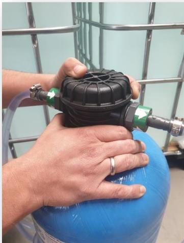
4. Rohwasser aufdrehen und warten bis Wasser an der Entlüftungsverschraubung austritt.
