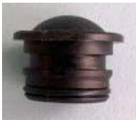
Rückspülverschluss, wird benötigt, um das Ventil als Filterventil einzusetzen.
